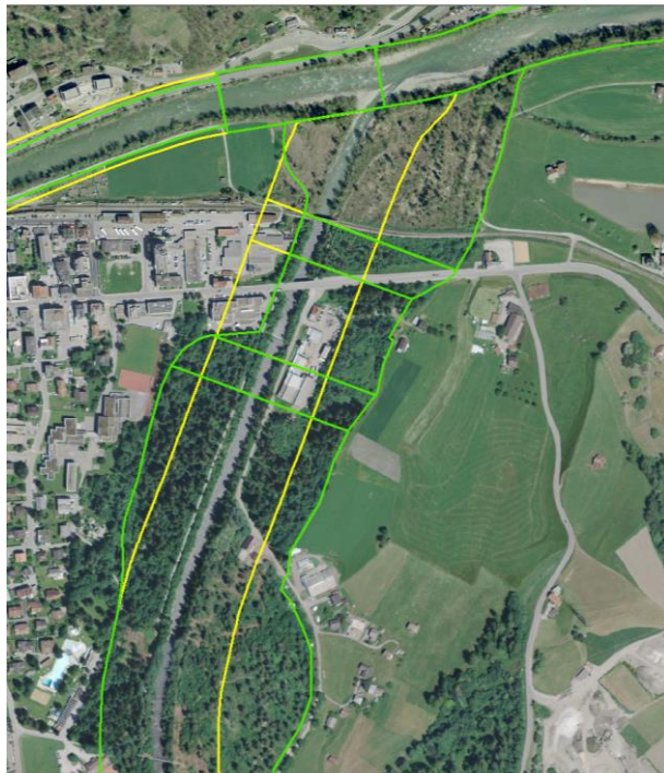
Bild 15: Der Gewässerraum des Glenners wird oberhalb der Mündung des Vorderrheins im Bereich der Stadt Ilanz/Glion auf den ursprünglichen Flussraum erweitert.
