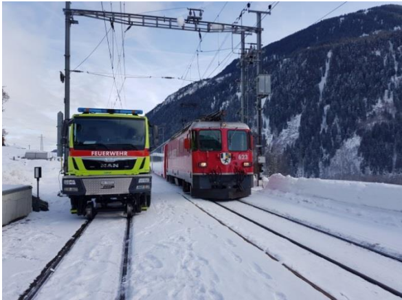
Vehichel dils pumpiers per il salvament en cass da barshaments dalla viafier.
